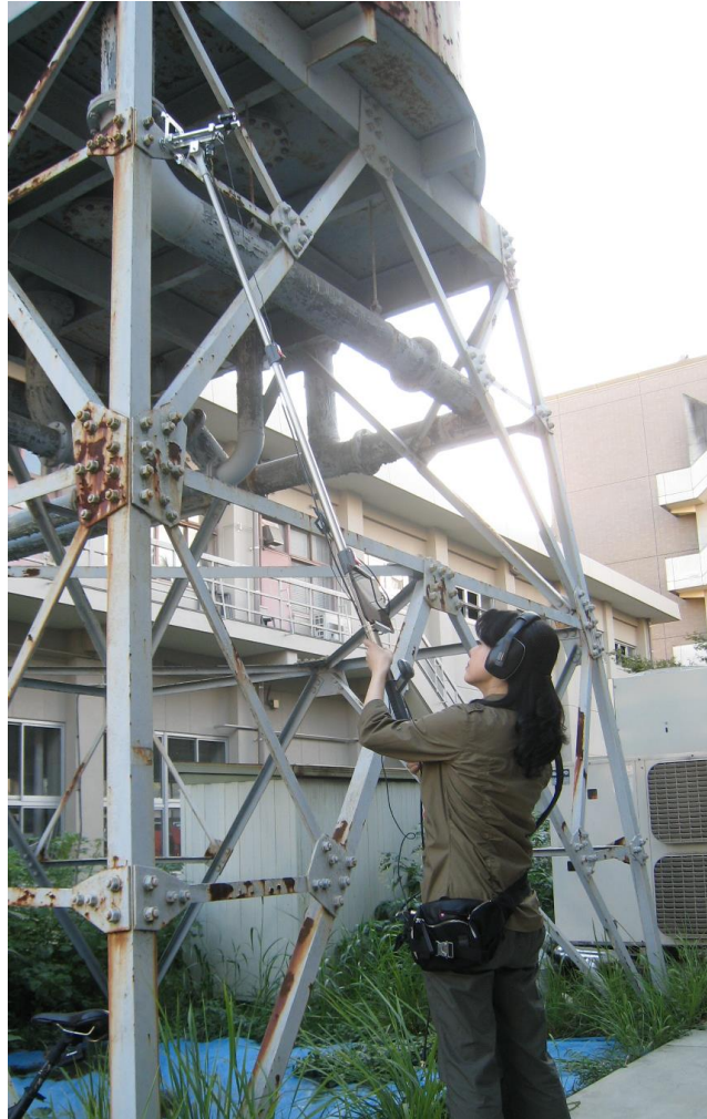
図4 簡易型高所打音検査装置
